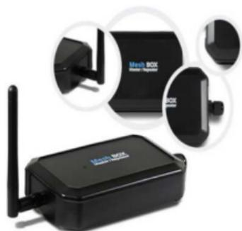
**FD-MESH** si basa sulla tecnologia Mesh a 2,4 GHz che crea reti senza fili estremamente affidabili grazie al fatto che ogni nodo funziona contemporaneamente sia da master di moduli RS485 che da repeater di segnali di altri FD-MESH rilanciandone il segnale. Con **FD-MESH** il terminale nell'edificio centrale, può controllare anche i lettori e gli I/O del cancello carraio nel parcheggio senza collegamenti fisici ma tutto tramite wireless.
